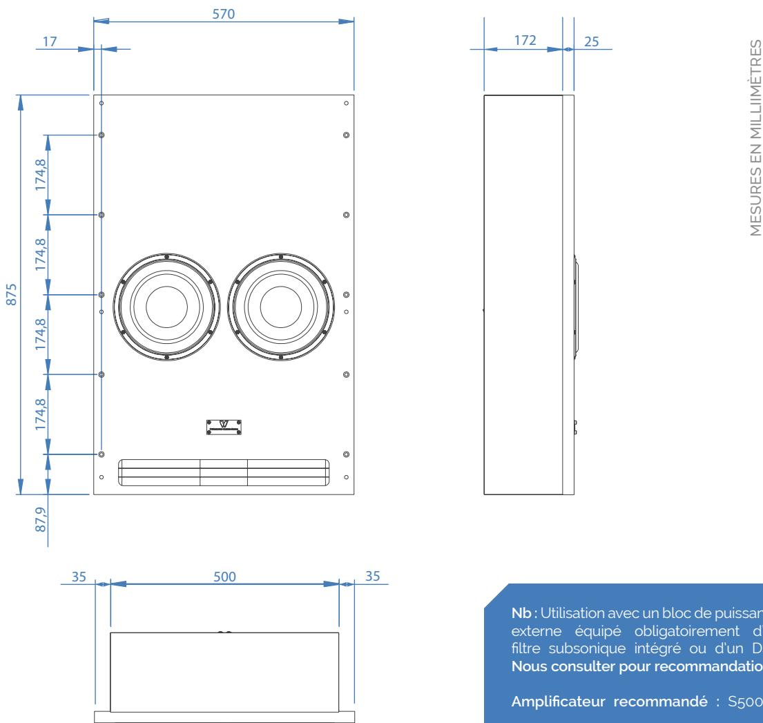
**Nb :** Utilisation avec un bloc de puissance externe équipé obligatoirement d'un filtre subsonique intégré ou d'un DSP.
